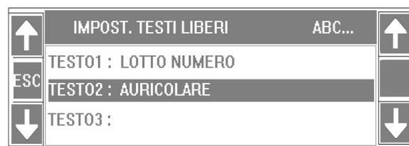
Posizionarsi mediante i tasti freccia sul testo che si intende modificare, scrivere il testo e passare al testo successivo sempre utilizzando i tasti freccia; quando terminato con l'impostazione premere il tasto ESC per uscire
