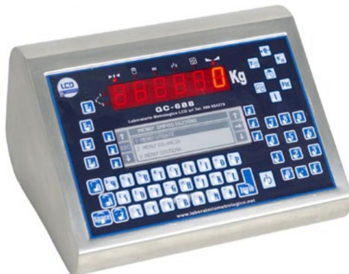
L'indicatore digitale di peso **GC-688** è indicato per l'utilizzo in qualsiasi condizione ambientale; è infatti dotato di serie di contenitore in Acciaio INOX AISI304 con display peso a led rossi h. 20 mm ad alta visibilità e display LCD grafico retroilluminato.
